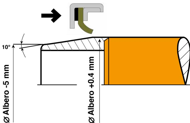
È da ricordare che il PTFE non ha un ritorno elastico come la gomma e pertanto, se durante il montaggio o l'immagazzinamento degli anelli il labbro di tenuta subisce una deformazione, essa richiede un'ispezione accurata prima del montaggio poiché potrebbe essere permanente e tale da rendere inutilizzabile l'anello.
